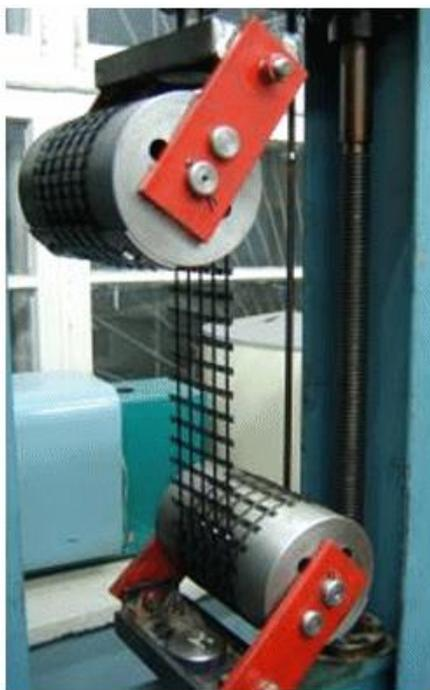
Рис. В.1 Определение предела прочности ГМ при растяжении
