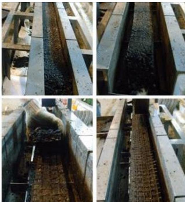
Рис. В.6.2. Процесс извлечения геосетки из конструкции
