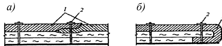
a – на плоской поверхности; б – на торцевом участке; 1 – соединяемые слои; 2 – анкер
