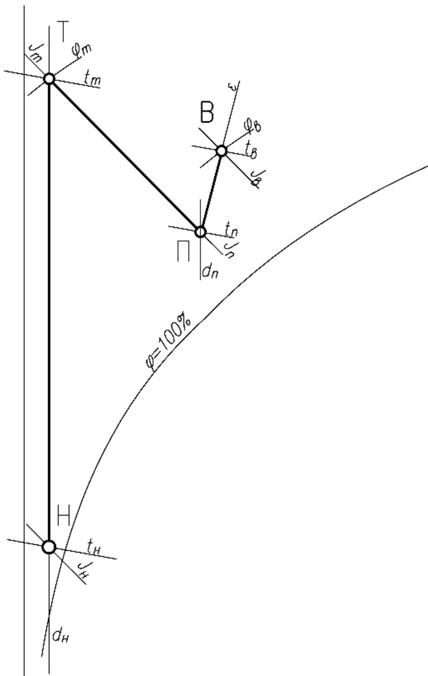
Рисунок 2 – Процесс обработки воздуха в центральных приточных системах кондиционирования воздуха в холодный период года
