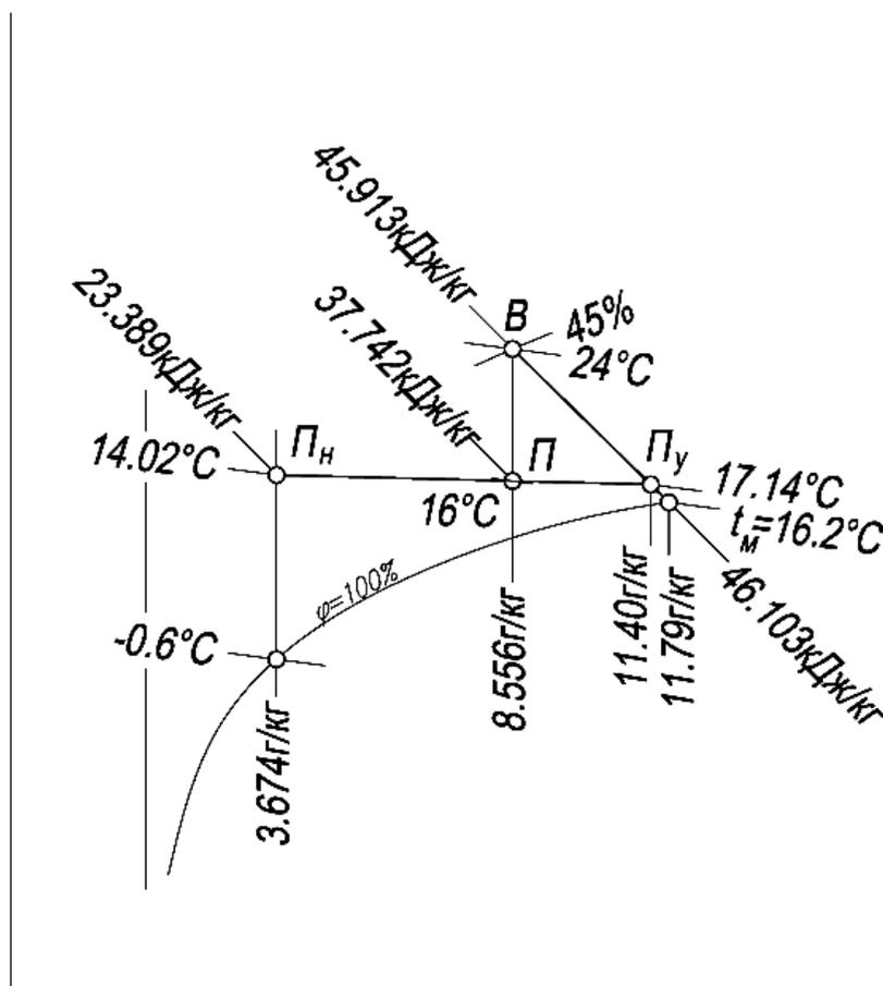
Рисунок 23 – Определение граничных параметров наружного воздуха
