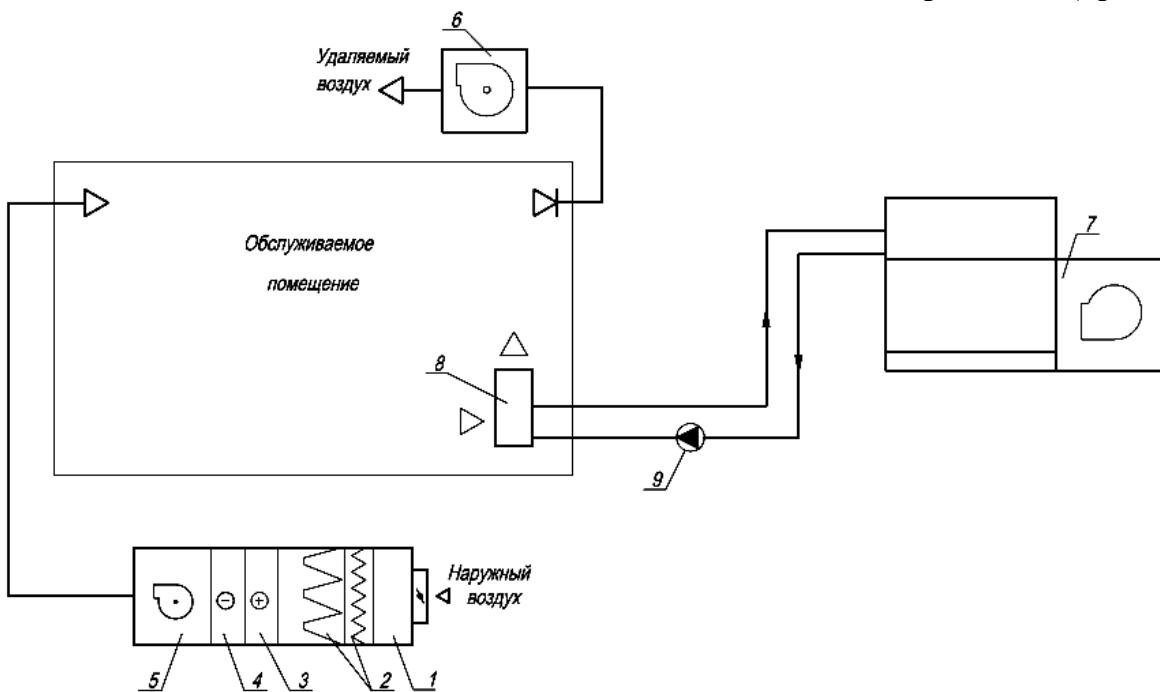
1 – приемная камера; 2 – воздушные фильтры; 3 – воздухонагреватель; 4 – воздухоохладитель; 5 – приточный вентилятор; 6 – вытяжной вентилятор; 7 – вентиляторная градирня; 8 – моноблок; 9 – циркуляционный насос
