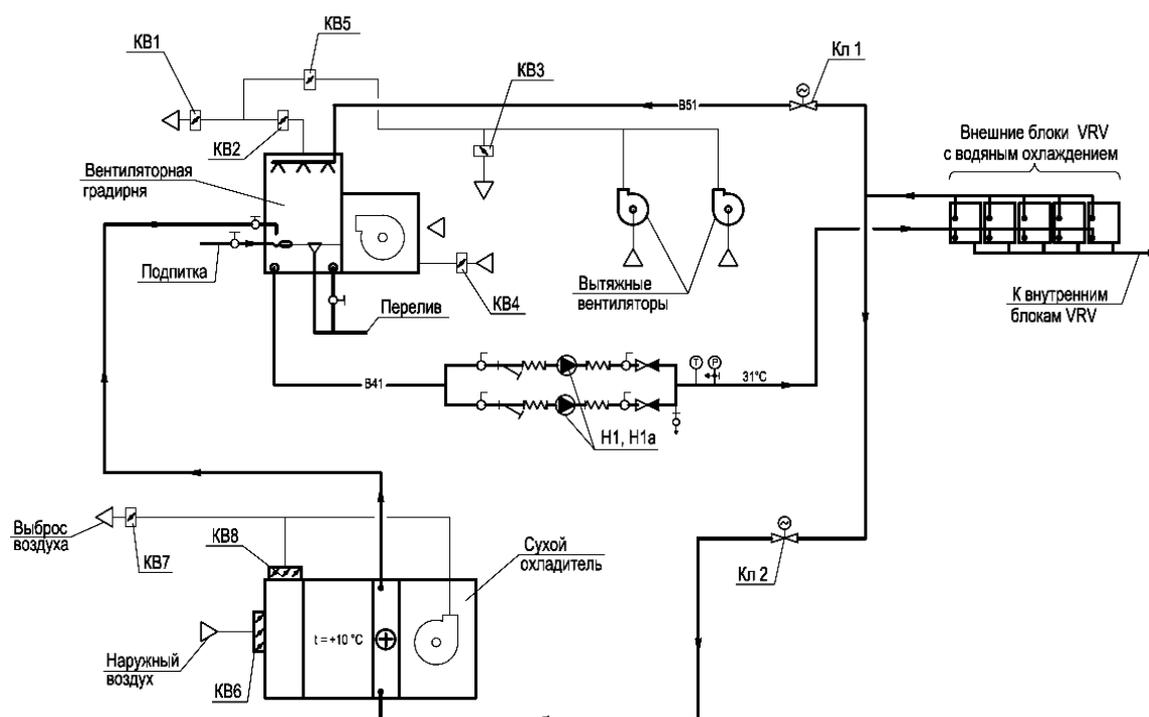
*KB* – клапан воздушный; *H1, H1a* – циркуляционные насосы; *Kл* – регулирующие клапаны на трубопроводе
