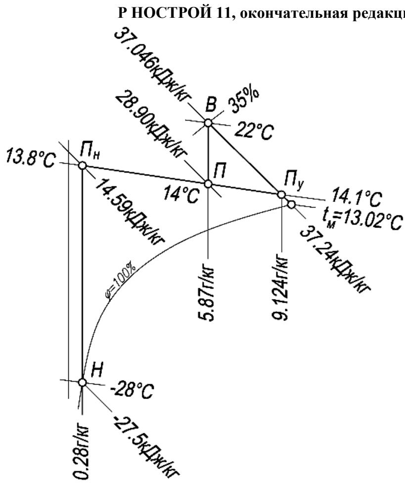
Рисунок 22 – Пример построения процессов обработки воздуха на *J-d* диаграмме в системе кондиционирования с местными адиабатическими увлажнителями
