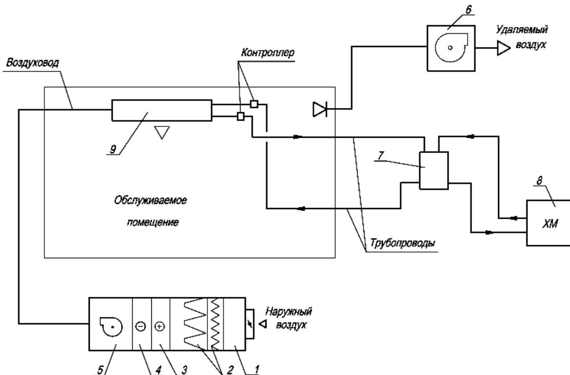
1 – приемная камера; 2 – воздушные фильтры; 3 – воздухонагреватель; 4 – воздухоохладитель; 5 – приточный вентилятор; 6 – вытяжной вентилятор; 7 – бак – аккумулятор; 8 – холодильная машина; 9 – активированная климатическая балка
