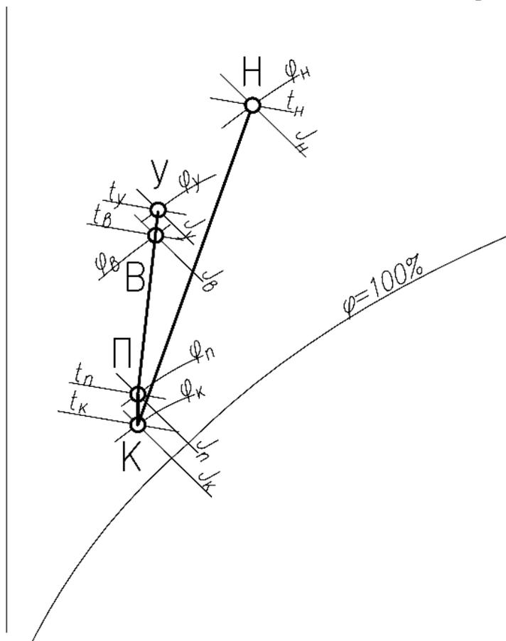
Рисунок 3 – Процесс обработки воздуха в центральных приточных системах кондиционирования воздуха в теплый период года
