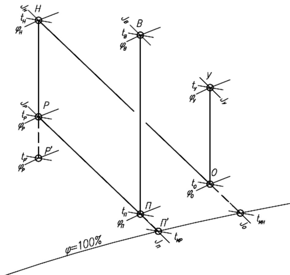
Рисунок 32 – Схема построения процессов обработки воздуха в центральной системе кондиционирования воздуха с двухступенчатым испарительным охлаждением.
