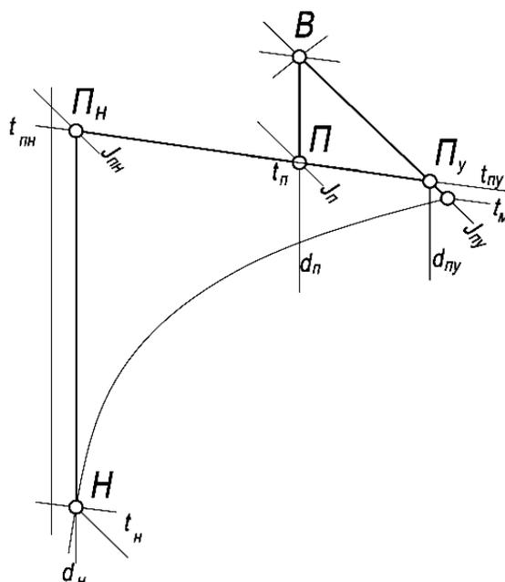
Рисунок 20 – Построение процесса обработки воздуха на  $J-d$  диаграмме в системе кондиционирования с местными адиабатическими увлажнителями
