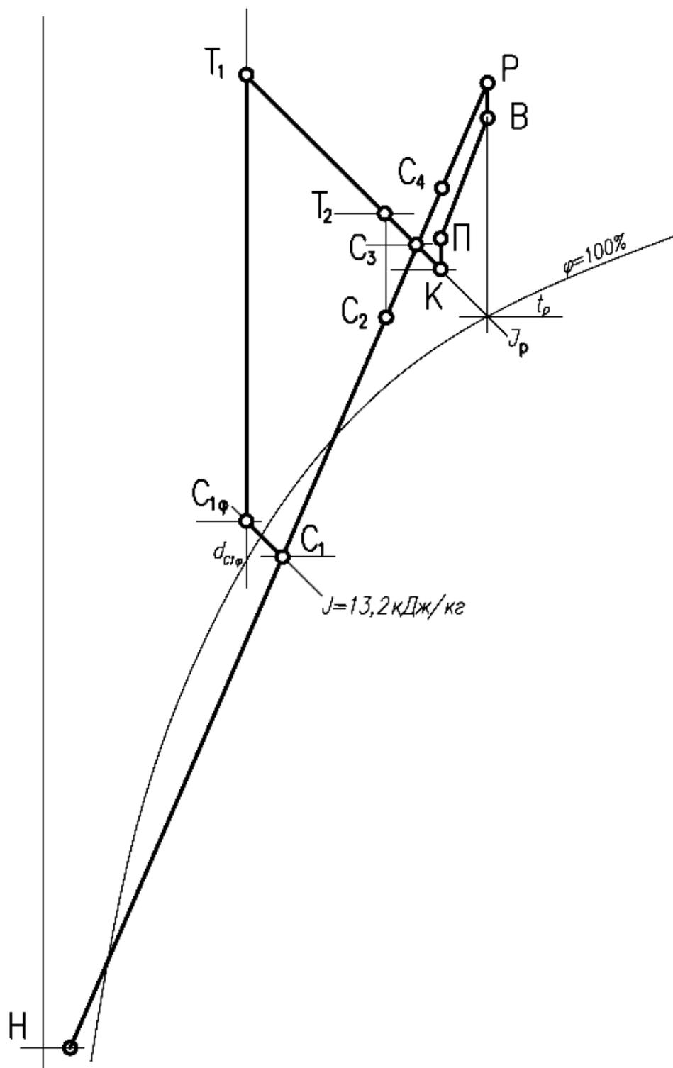
Рисунок 6 –  $J-d$  диаграмма процессов обработки воздуха в системе кондиционирования воздуха с переменной первой рециркуляцией с вариантами расположения точек смеси
