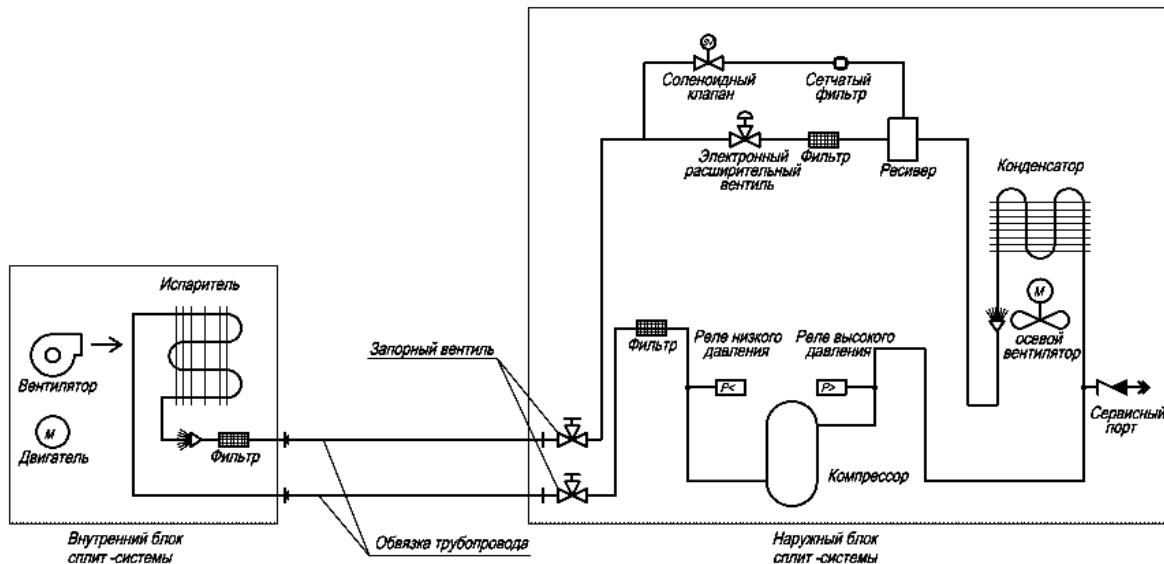
Рисунок 14 – Принципиальная схема устройства сплит-системы.
