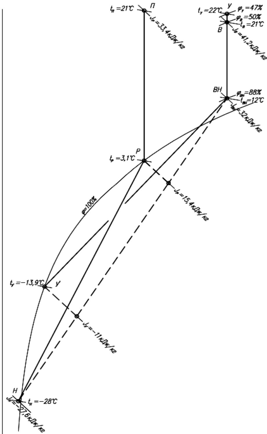
Рисунок 31 – J-d диаграмма процессов обработки воздуха в центральной системе кондиционирования с косвенным испарительным охлаждением в холодный период года (режим разогрева помещений)
