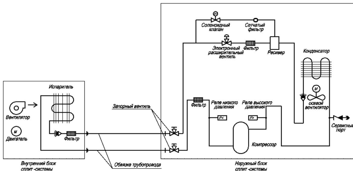
Рисунок 14 – Принципиальная схема устройства сплит-системы.
