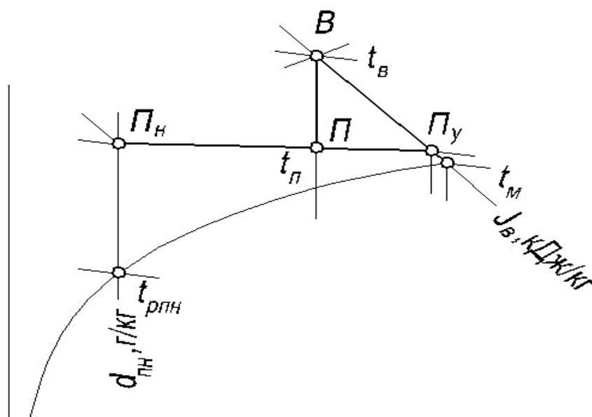
Рисунок 21 – Процесс определения граничного состояния наружного воздуха в системах кондиционирования воздуха с адиабатными увлажнителями
