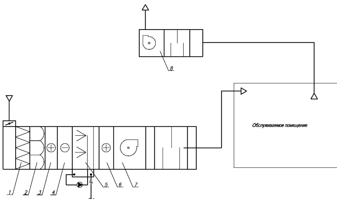
1 – воздушный фильтр грубой очистки; 2 – воздушный фильтр тонкой очистки; 3 – воздухонагреватель первого подогрева; 4 – воздухоохладитель; 5 – камера орошения; 6 – воздухонагреватель второго подогрева; 7 – приточный вентилятор; 8 – вытяжной вентилятор
