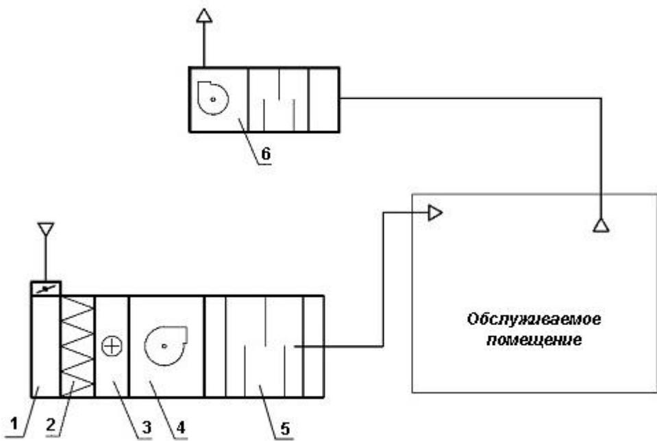
1 – приемная секция; 2 – воздушный фильтр грубой очистки; 3 – воздухонагреватель; 4 – приточный вентилятор; 5 – шумоглушитель; 6 – вытяжной вентилятор
