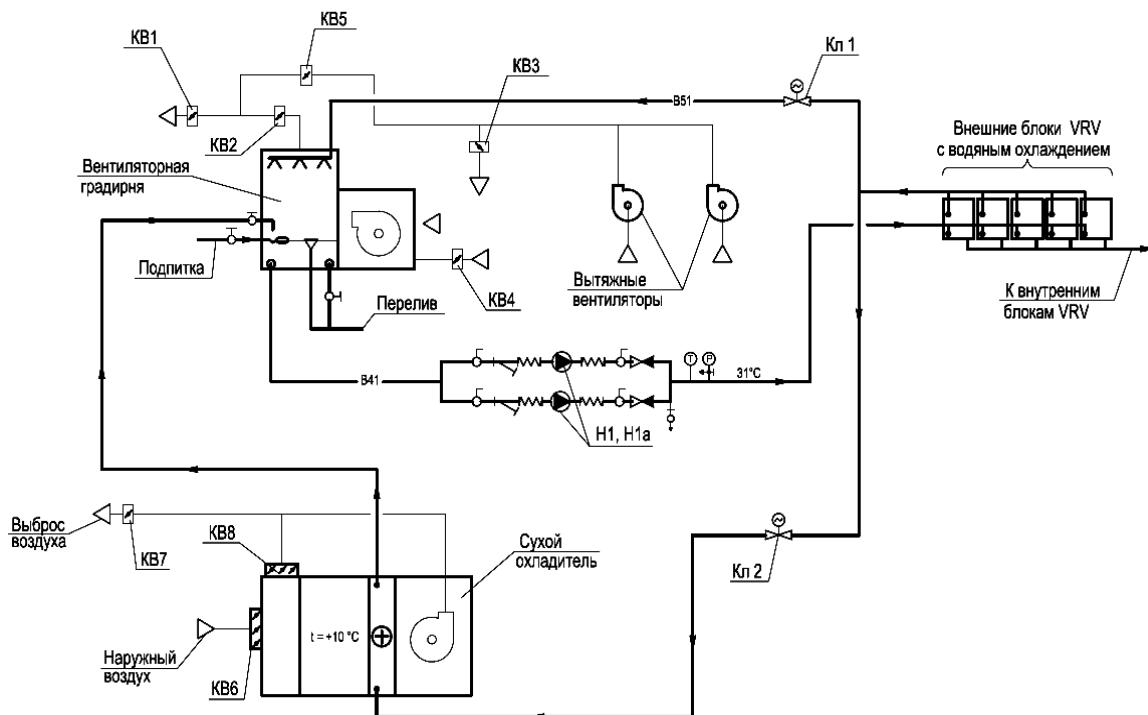
*KB – клапан воздушный; H1, H1a – циркуляционные насосы; Кл – регулирующие клапаны на трубопроводе*
