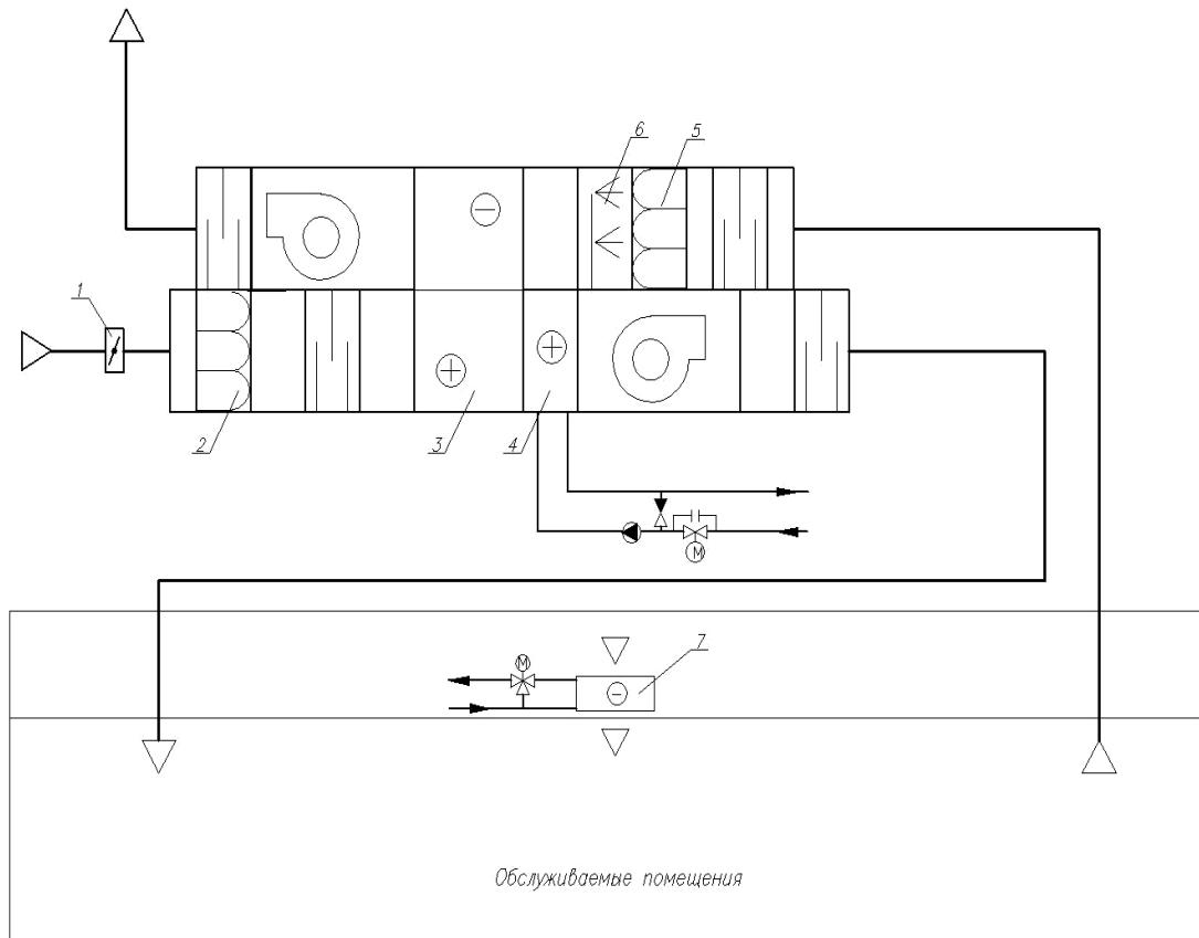
1 – клапан наружного воздуха; 2 – воздушный фильтр (приточный воздух); 3 – роторный утилизатор; 4 – воздухонагреватель; 5 – воздушный фильтр (вытяжной воздух); 6 – адиабатический увлажнитель; 7 – местный доводчик
