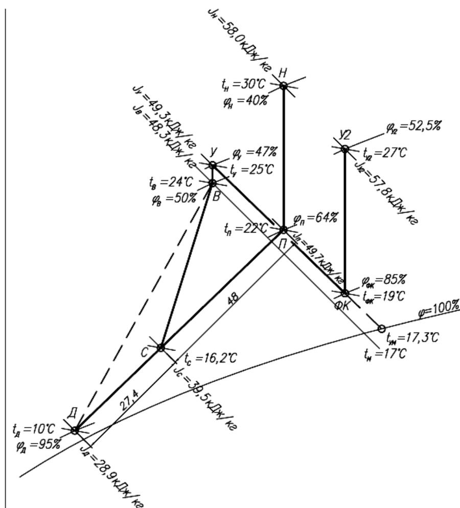
Рисунок 29 –  $J-d$  диаграмма процессов обработки воздуха в центральной системе кондиционирования с косвенным испарительным охлаждением и местными доводчиками
