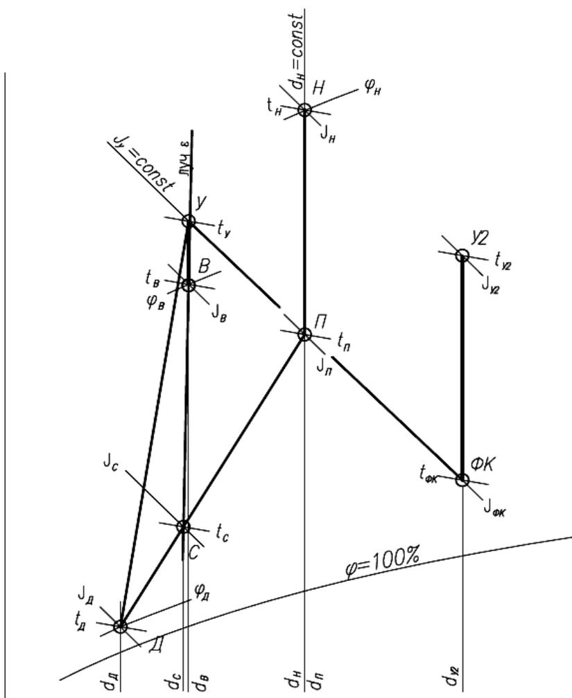
Рисунок 27 – Схема построения процессов обработки воздуха в центральной системе кондиционирования с косвенным испарительным охлаждением и местными доводчиками
