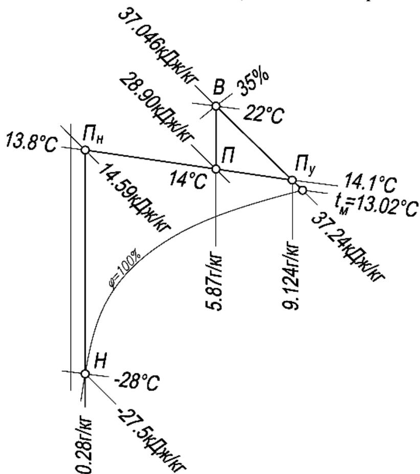
Рисунок 22 – Пример построения процессов обработки воздуха на  $J-d$  диаграмме в системе кондиционирования с местными адиабатическими увлажнителями
