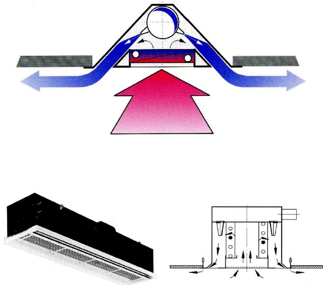
**Рисунок 16 – Общий вид устройства активированной климатической балки**
