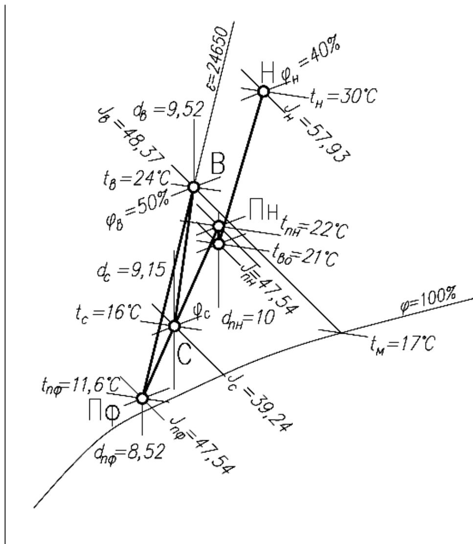
Рисунок 10 – Пример процесса обработки воздуха на  $J-d$  диаграмме в системах кондиционирования воздуха с местными доводчиками (фэнкойлами).
