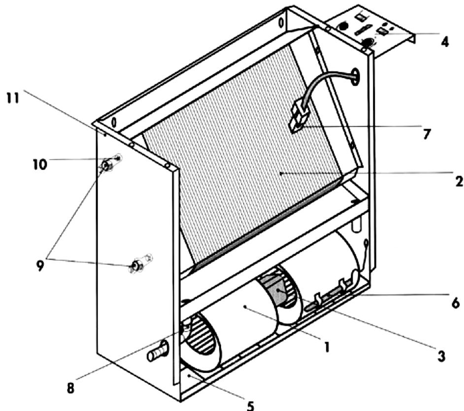
1 – вентилятор; 2 – теплообменник; 3 – электродвигатель; 4 – панель управления; 5 – воздушный фильтр; 6 – комнатный термостат; 7 – зонд минимальной температуры воды; 8 – вывод конденсата; 9 – подсоединение к водопроводной сети;
