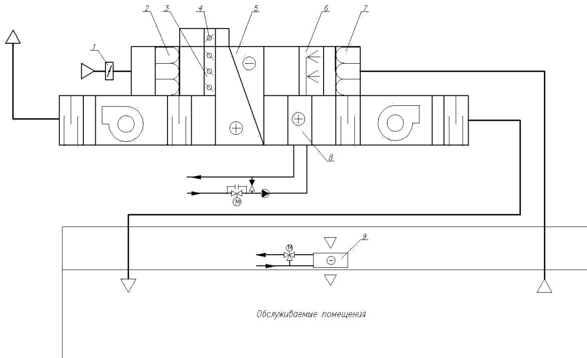
1 – клапан наружного воздуха; 2 – воздушный фильтр (приточный воздух); 3,4 – клапаны обводного канала; 5 – пластинчатый теплообменник «воздух-воздух»; 6 – адиабатический увлажнитель (вытяжной воздух); 7 – воздушный фильтр (вытяжной воздух); 8 – воздухонагреватель (приточный воздух); 9 – местный доводчик
