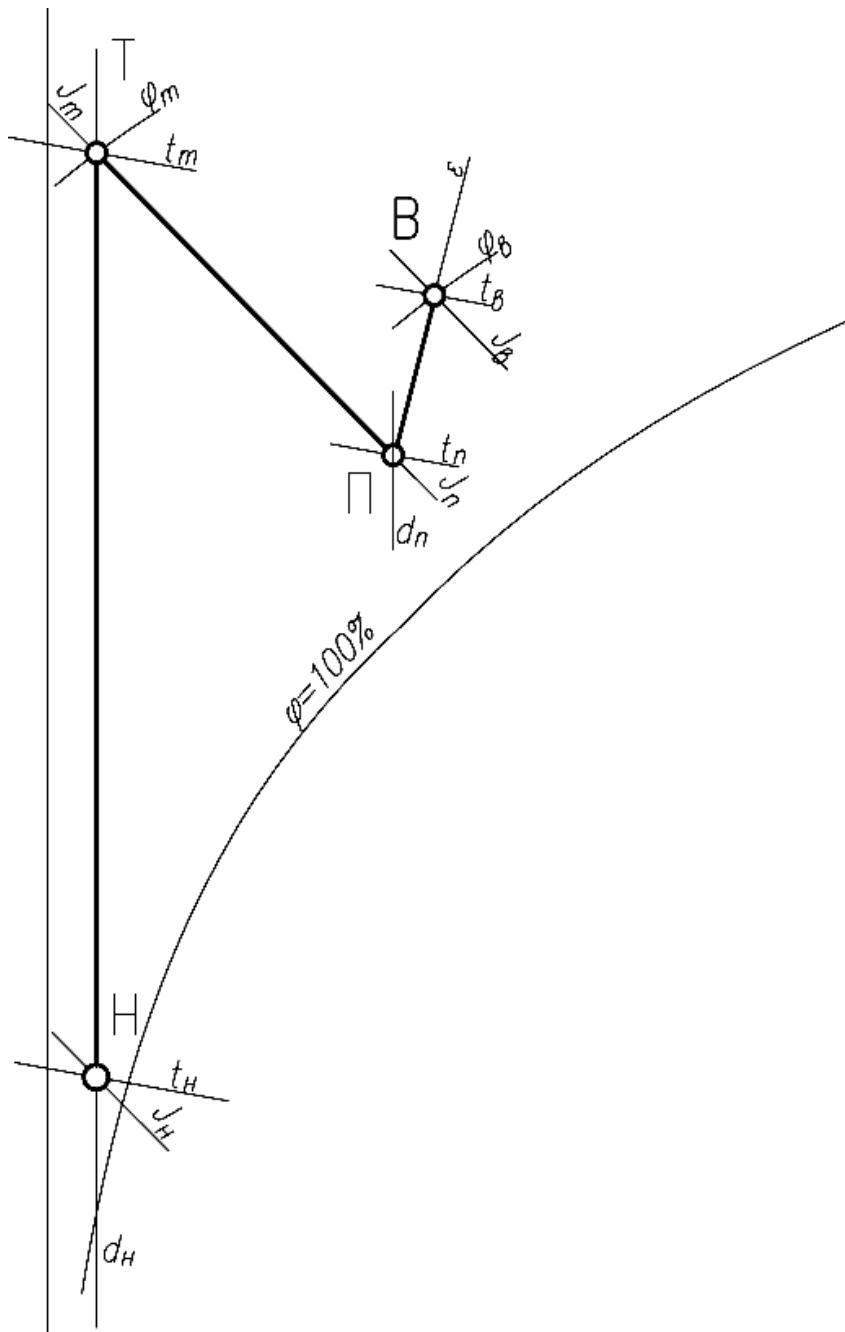
Рисунок 2 – Процесс обработки воздуха в центральных прямоточных системах кондиционирования воздуха в холодный период года
