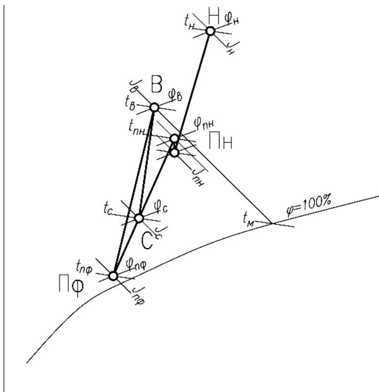
Рисунок 9 –  $J-d$  диаграмма обработки воздуха в системах кондиционирования воздуха с местными доводчиками - фэнкойлами.
