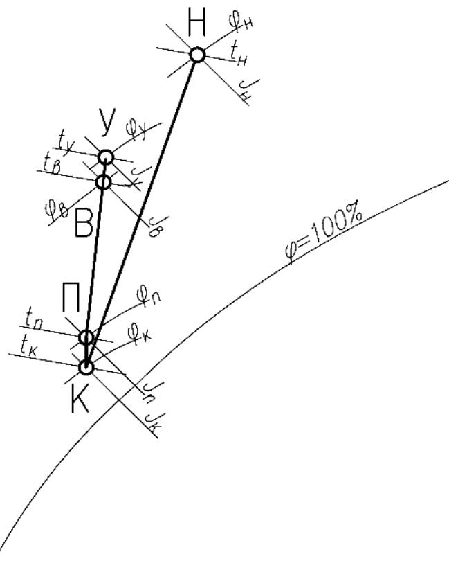
Рисунок 3 – Процесс обработки воздуха в центральных прямоточных системах кондиционирования воздуха в теплый период года
