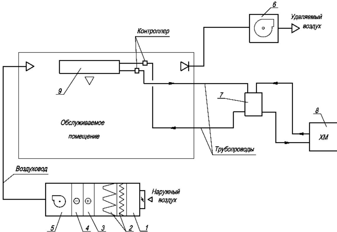
1 – приемная камера; 2 – воздушные фильтры; 3 – воздухонагреватель; 4 – воздухоохладитель; 5 – приточный вентилятор; 6 – вытяжной вентилятор; 7 – бак – аккумулятор; 8 – холодильная машина; 9 – пассивная климатическая балка
