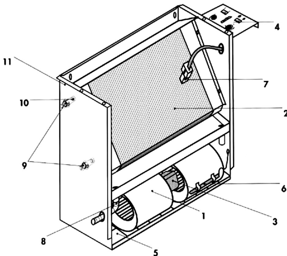
1 – вентилятор; 2 – теплообменник; 3 – электродвигатель; 4 – панель управления; 5 – воздушный фильтр; 6 – комнатный термостат; 7 – зонд минимальной температуры воды; 8 – вывод конденсата; 9 – подсоединение к водопроводной сети; 10 – воздушный клапан; 11 – корпус
